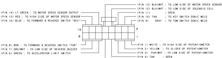
16 - PIN CONNECTOR AT CONTROLLER
